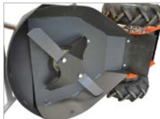
Spezielles Messer sorgt dafür, dass sich kein Gras um die Messerwelle wickelt.
